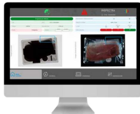
Pantalla de panel de control en equipo Thermoseal Inspector Standard
