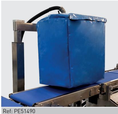
**Funda protectora para limpieza para etiquetadora superior**
